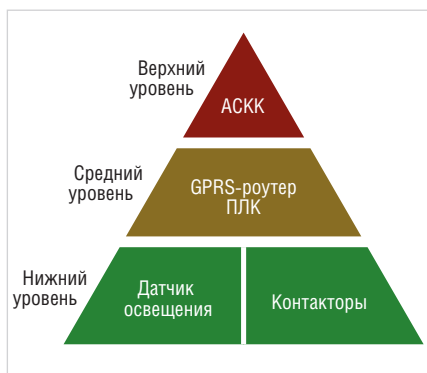
Рис. 8. Классическая трёхуровневая архитектура систем диспетчерского контроля
